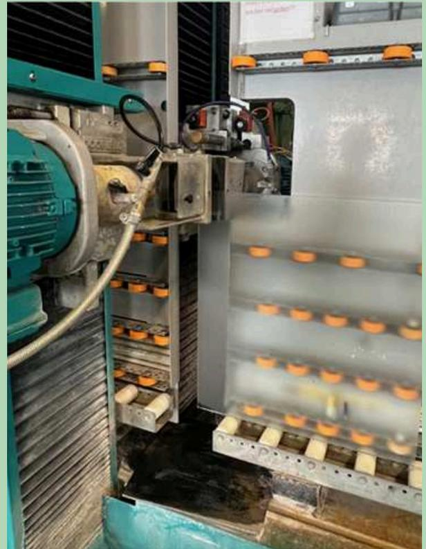
*Abb. 34: Bohren der Ladekabel-Öffnung auf Rückwand*
