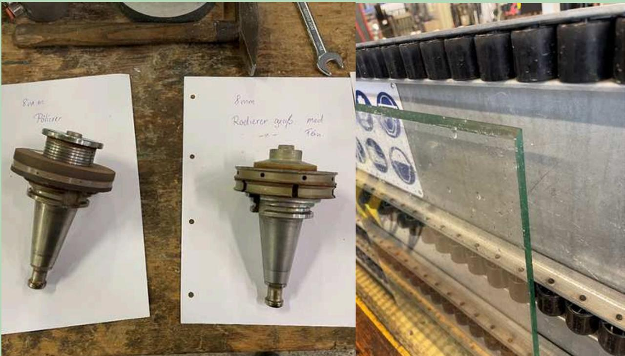
*Abb. 16: An der Schleifmaschine durchgeführte 45 Grad Gehrungen*
