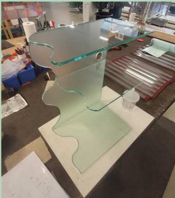
*Abb. 35: Mit Pyrosil und Aceton gereinigte Kanten*
