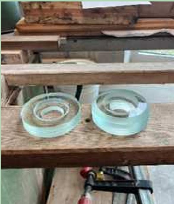
*Abb. 23: Mit EP3-Rundschleifer bearbeitete Auflagen fürs Kugellager*
