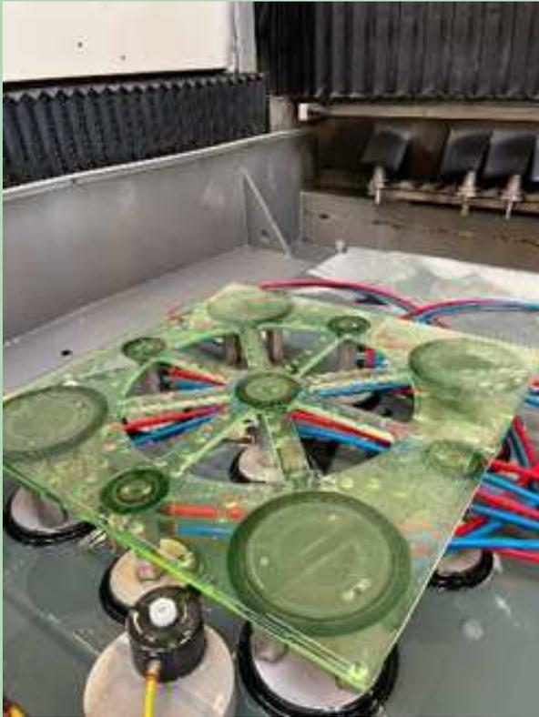
*Abb. 21: CNC-Bearbeitung des Rads*
