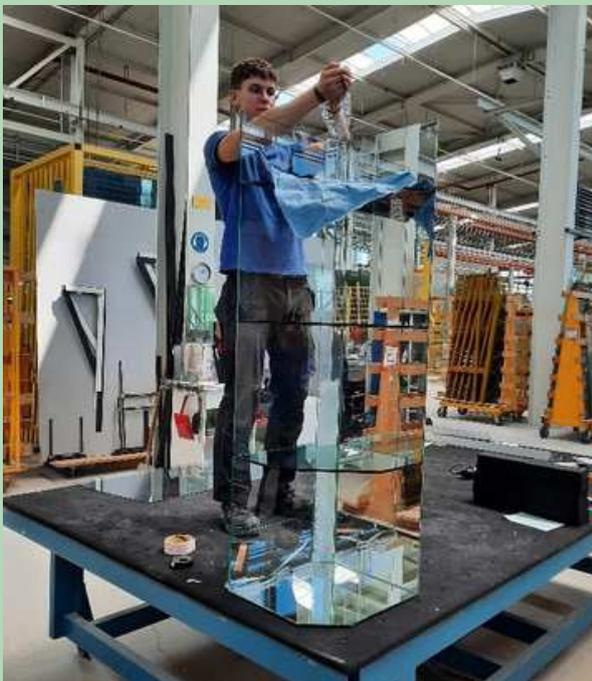
*Abb. 11: Einfüllen der ESG-Krümel*
