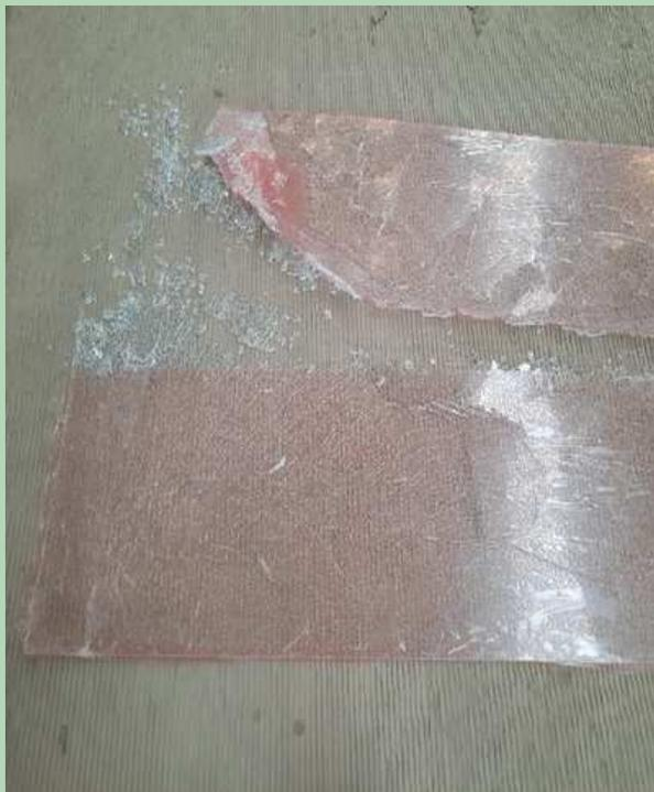
*Abb. 7: Das zerschlagene ESG mit Splitterschutzfolie*
