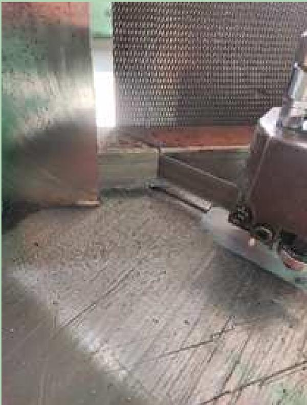
*Abb. 27: Zuschneiden und Zusammenfügen der 40x40 Vierkant-Rohre*
