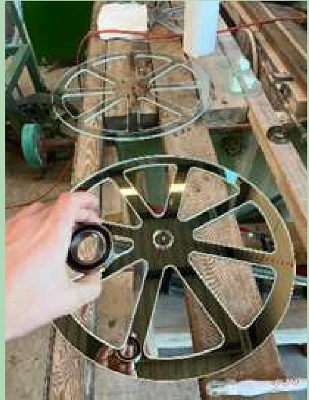
*Abb. 22: Schneiden und Rodieren des äusseren Kreises von Hand*
