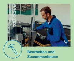
Glas zuschneiden, Kanten schleifen, Bohren und Fräsen maschinell oder von Hand.
